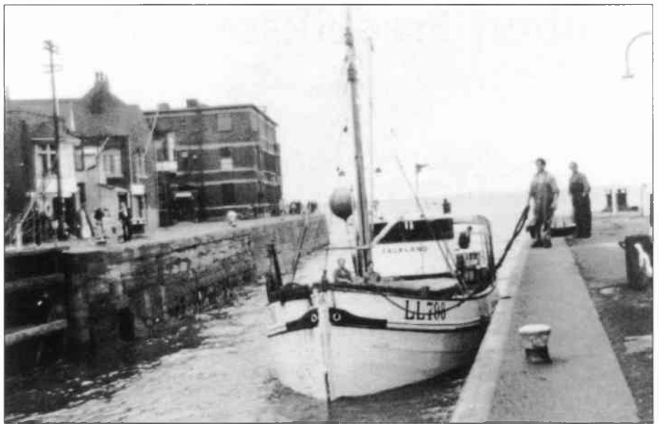
LL 798 Falkland har här anlänt till Hull i England med last, troligen någon gång i mitten av 1950-talet. Det tidigare mindre däckshuset har här ersatts med ett större av metall. Foto: Holger Olsson.
