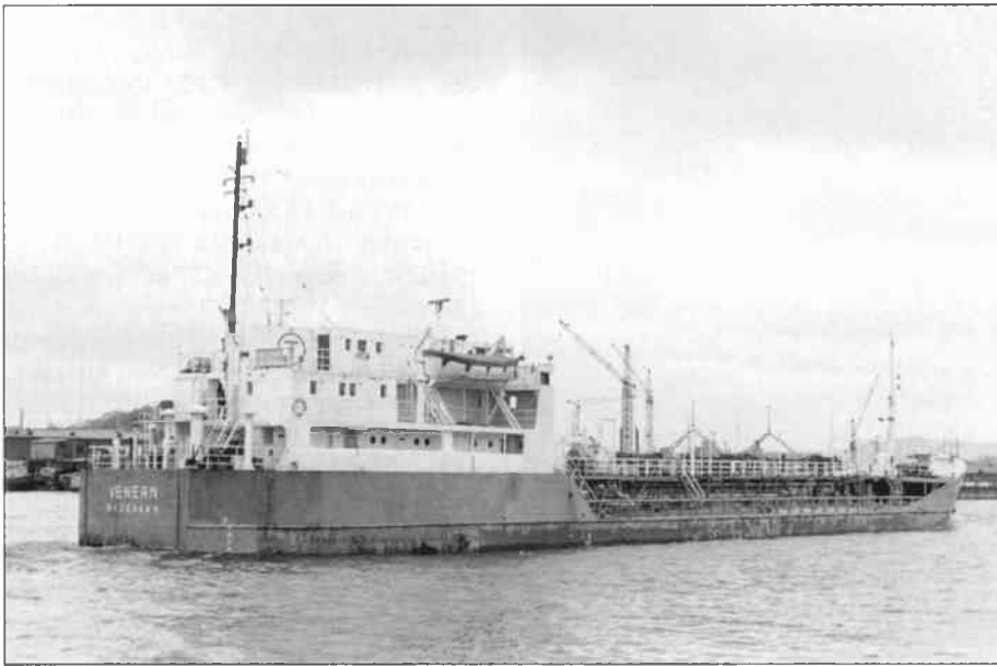
Man ser tydligt att slussarna till Vänern fått bestämma tankern Venerns utseende. Foto den 25 april 1972 av Krister Bång.
