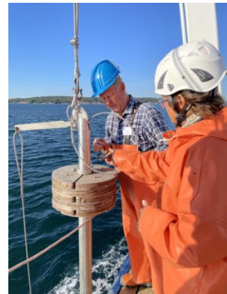
Till höger: Sedimentprovtag med kolvlod.
