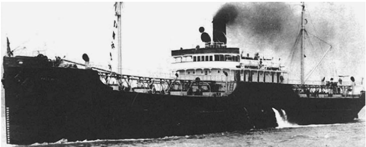
S/S Palo Alto, ett av de experimentella och ABS-klassade fartygen som byggdes i betong.
