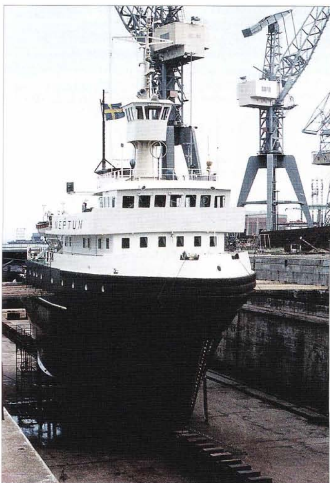
Neptun i torrdocka hos Kockums i Malmö. Bilden visar tydligt hennes stora djupgående.
