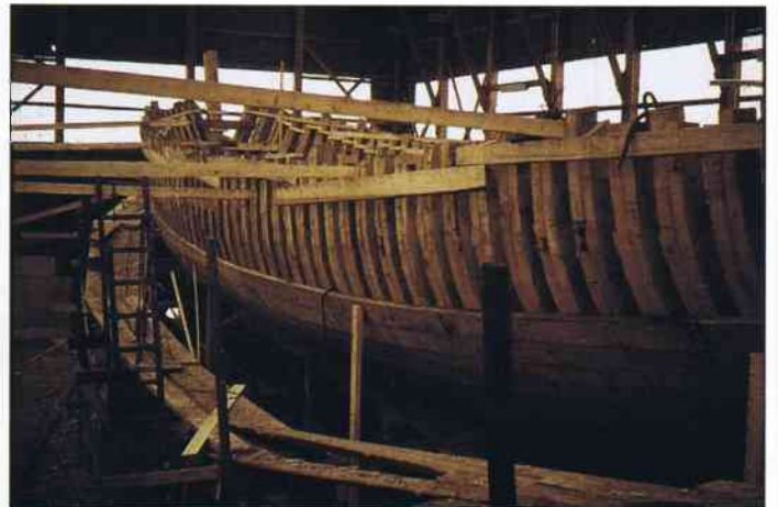
Efter några månaders arbete är minsveparen nästan bordfylld. Skeppsbyggmästare var Verner Olsson från Skredsvik.
