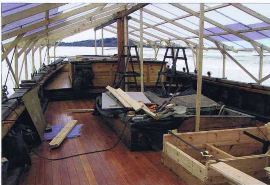
Ännu återstår en del att göra innan seglingarna kan börja senare i år. Däcket är av oregon pine.
