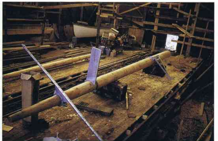
Samtidigt som minsveparen Gåssten byggdes tillverkades utrustningen till fartyget som t ex rundhult.
