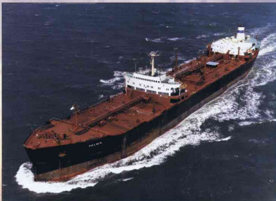
Palma, motortankfartyg på 56 000 dwt. Palma levererades från Götaverken Arendal 1964 och var en av de allra sista tankfartygen med midskepps-däckshus. Foto Skyfotos
