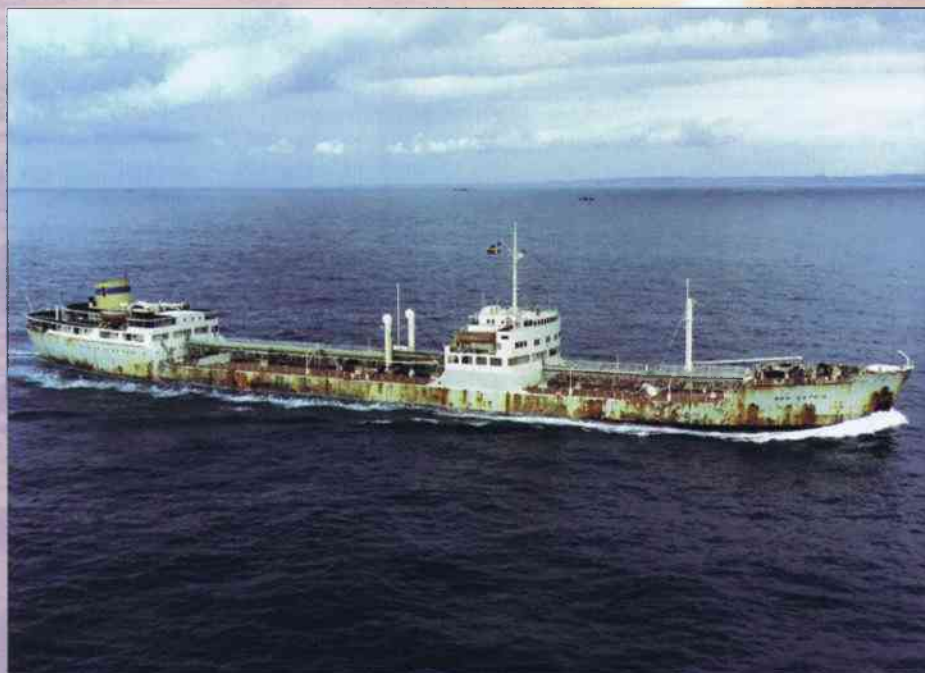
Palma, motortankfartyg på 56 000 dwt. Palma levererades från Götaverken Arendal 1964 och var en av de allra sista tankfartygen med midskepps-däckshus. Foto Skyfotos
